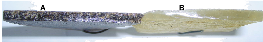
Figura 1. Piezas fracturadas A) pieza con 10% de fibra, B) pieza sin fibra.
