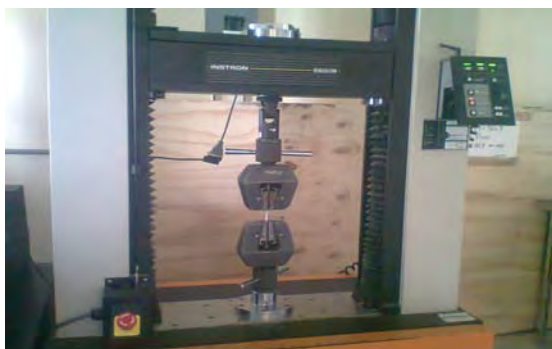
Figura 8. Prueba de tensión en la Máquina de Pruebas Universales INSTRON.
