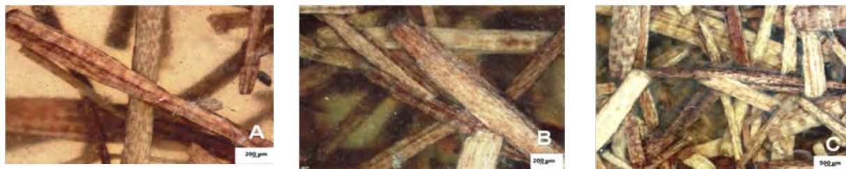
Figura 5. Imágenes de microscopio estereoscópico de los compósitos con 5% (A), 10% (B) y 30% (C) de partículas de madera de eucalipto.
