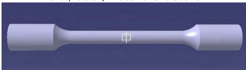
Ilustración 1 Geometría de las piezas inyectadas.
