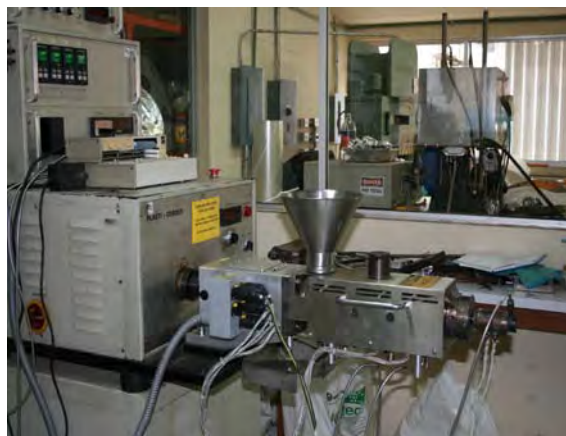
Figura 2. Extrusor doble husillo utilizado para generar las distintas formulaciones
