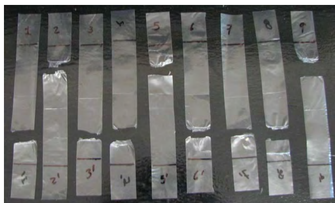
Figura 10. Probetas ensayadas en dirección transversal
