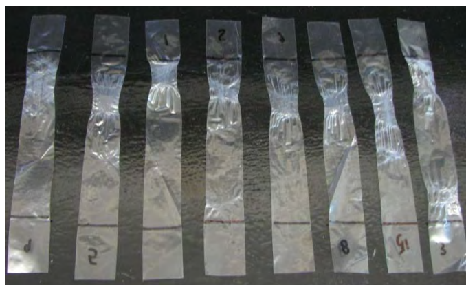
Figura 9. Probetas ensayadas en dirección longitudinal
