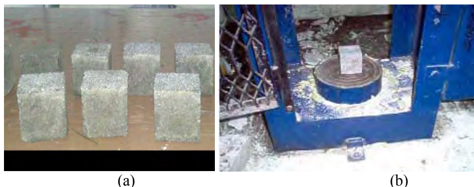
Figura 3. (a) Especímenes de mortero hidráulico adicionados con PET , (b) Ensaye a compresión.
