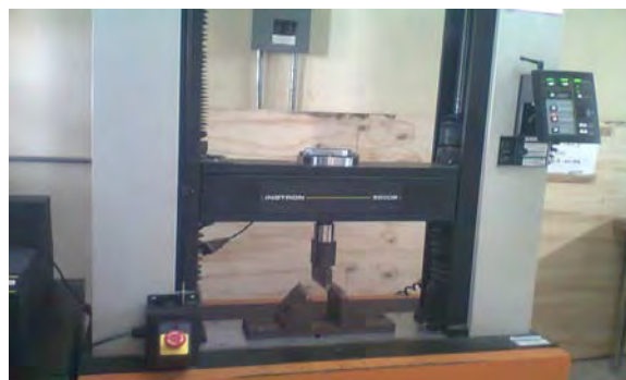
Figura 9. Prueba de flexión.
