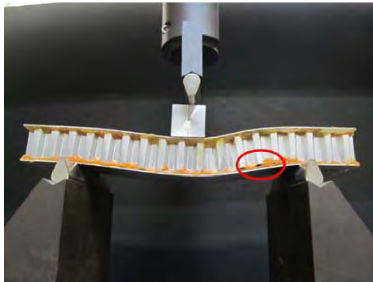
Figura 8. Panel probado a flexión posterior a su prueba.
