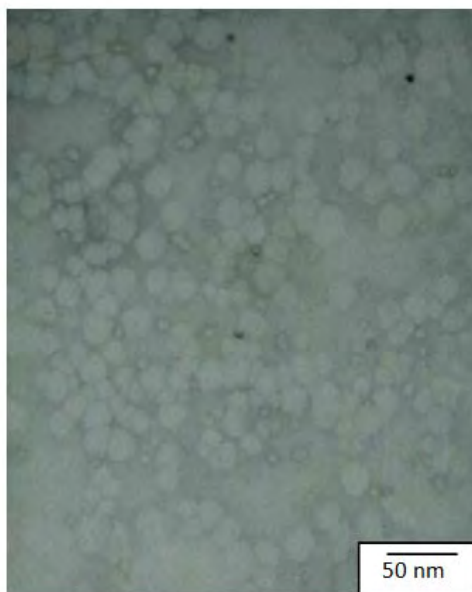
Figura 3. Micrografía obtenida por TEM del látex obtenido con 13% de tensoactivo.
