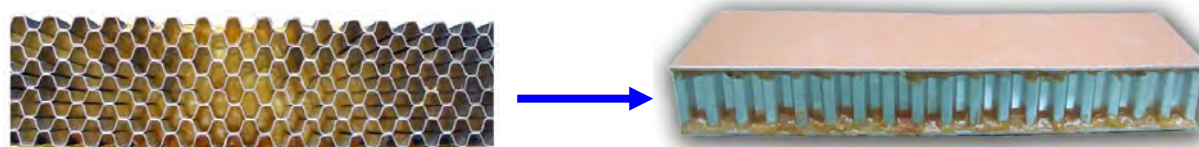
Figura 2. Elaboración del panel sándwich tipo honeycomb .
