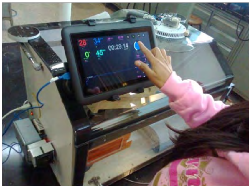
Figura 1 Sistema de electrohilado con control de temperatura e interfase táctil para controlar los procesos.
