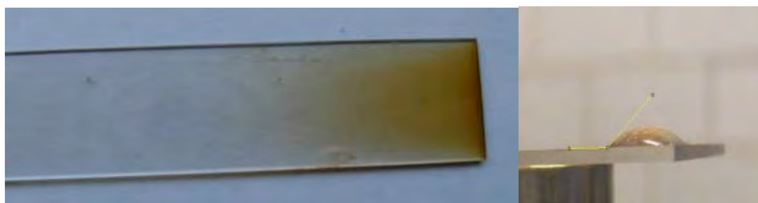
(a) (b) Figura 3. Gradiente de Polipirrol por plasma (a) y medida de ángulo de contacto (b)
