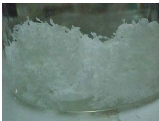
Figura 3. HDPE obtenido en la polimerización de etileno a 30°C con el complejo [iPr-Cp_2ZrH_2AlH_2]^+[HB(C_6F_5)_3]^- en hexano/heptano (Exp PE14, Tabla 2)
