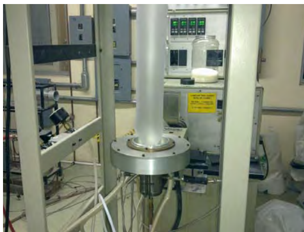
Figura 7. Obtención de la burbuja por proceso de soplado
