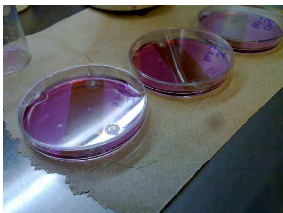
Fig. 3. Substratos de vidrio recubiertos con PPy-I en el medio de cultivo celular.
