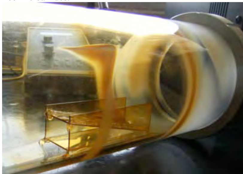
Figura 2. Geometría utilizada para la formación del gradiente dentro del reactor.
