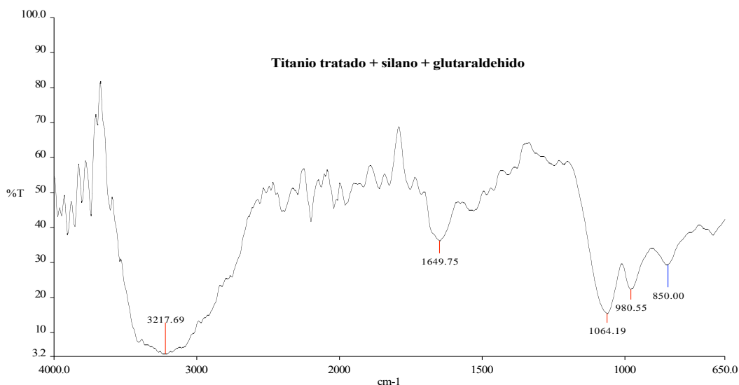
Fig. 5. Espectro de FT-IR-ATR del titanio silanizado y modificado posteriormente con glutaraldehído.
