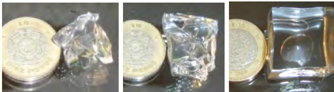
Figura 9 Macroestructura de hidrogeles hidratados a: a) 1 h, b) 3 h, c) 8 h. Hidrogel con 8.0 % de agente reticulante de la zona 1 (temperatura 64-80 °C).
