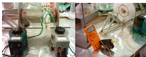
Figura 2.- Controles para la temperatura (reóstatos y multímetro).
